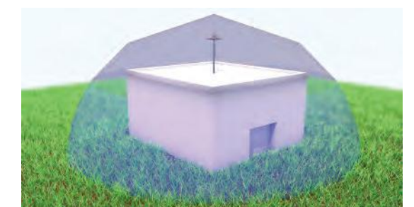
Fig. 4 - ESE protection volume.
