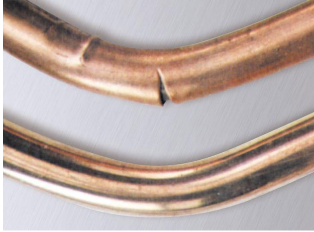
Şekil 76. Bakır bağı ve bakır kaplı topraklama çubukları
