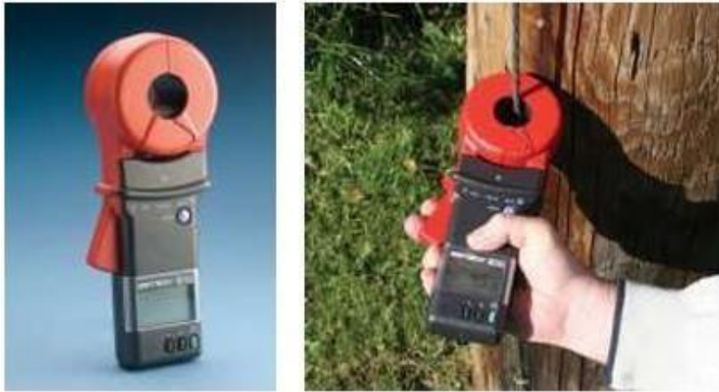
Şekil 74. nVent ERICO'nun direnç ve özgül direnç ölçümleri için test ekipmanları
